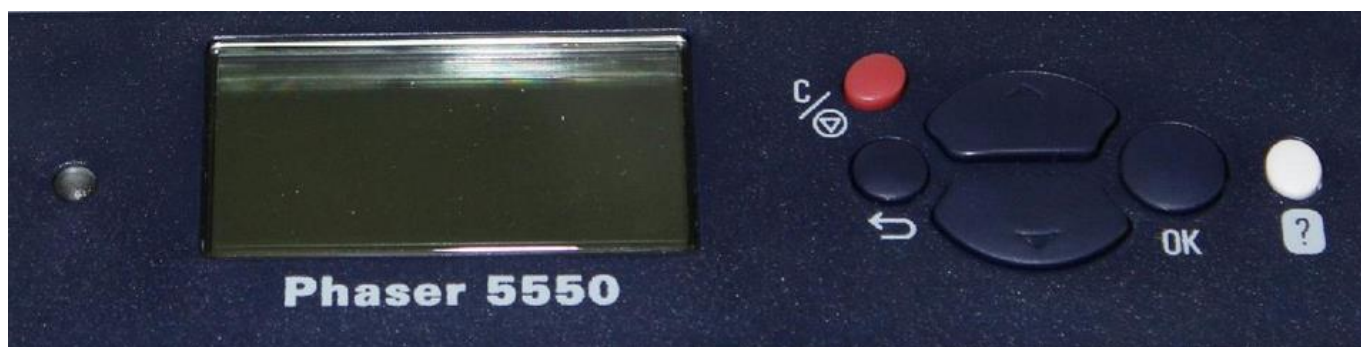
Il pannello di controllo e il display della stampante Xerox Phaser 5550. Da notare il led sulla sinistra: verde=OK; arancio=avviso; rosso=errore bloccante
